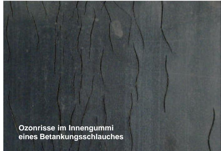
Ozonrisse im Innengummi eines Betankungsschlauches
