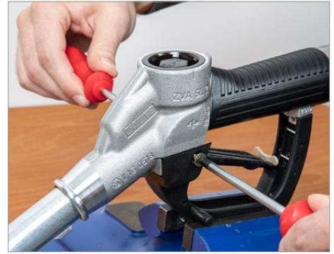
Bügelschraubengarnitur mit Schraubendrehern einschrauben.
