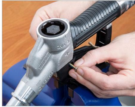
Bügelschrauben EB 438.1 einsetzen.
