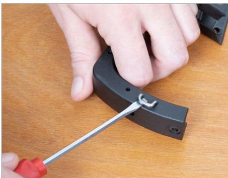
Rastenstecker mit Schlitzschraubendreher entfernen.
