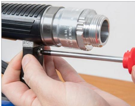
Senkschraube mit Mutter EB 278 lösen.
