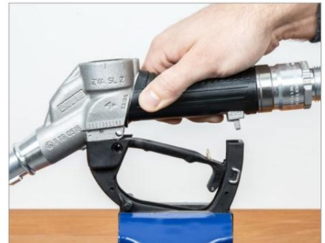
Gehäuse abnehmen und Bügel aus Schraubstock entfernen. Dabei beachten, dass die Bolzen EB 235 nicht rausfallen.
