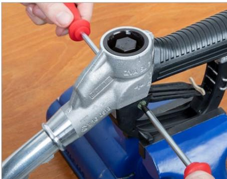
Bügelsschrauben EB 438.1 mit 'Schraubendrehern lösen.
