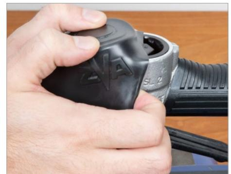
Mit Fingern unter Schutzüberzug EK 044 greifen und über das Ablaufrohr abziehen.
