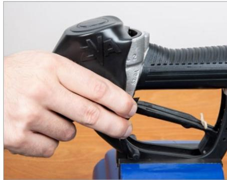
Schutzüberzug EK 144 über das Auslaufrohr auf das Gehäuse schieben. Dann über das Gehäuse drücken.
