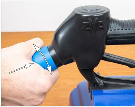
Sortentülle EK 043 (oder Spritzschutz EK 652) auf Schutzüberzug schieben und so lange drehen, bis diese einschnappt.
