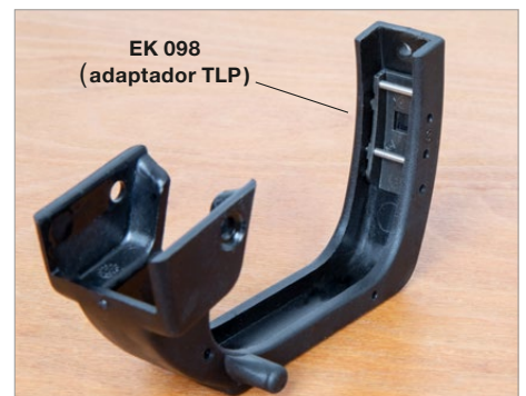
Inserte el EK 098 (adaptador TLP) inclinado en la manija y luego presione hasta hacer 'click'. Insert EK 098 (TLP adapter) tilted into the guard, then click it into the guard.
