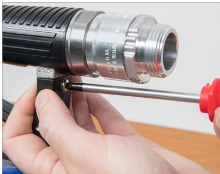
Afloje también el tornillo trasero con la tuerca EB 278. Unscrew rear screw with nut EB 278.
