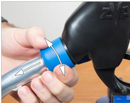
Con un movimiento giratorio, retire el manguito plástico EK 043 (o protector contra salpicaduras EK 652) hacia la punta del surtidor. With a turning movement, pull off product sleeve EK 043 (or splashguard EK 652) towards the spout tip.
