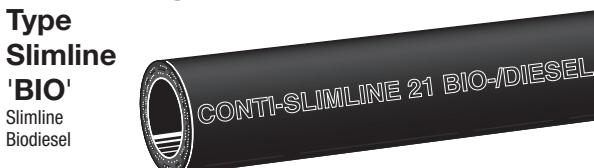
Flexible 'CONTI-SLIMLINE' de haute qualité pour essence et diesel. Convient également pour essences contenant de l'éthanol jusqu'à E 85. Peut être éalonner pour pompes électriques, voir au verso. Résistant au froid jusqu'à -30°C (type LT jusqu'à -40°C).
