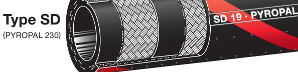
**Flexible vapeur :** pour le vapeur saturé jusqu'à 18 bar (210°C) et l'eau chaude jusqu'à 120°C. Pour l'eau chaude jusqu'à 25 bar. Ne convient pas pour les eaux à teneur en huiles. Répond aux standards EN ISO 6134 type 2A.
