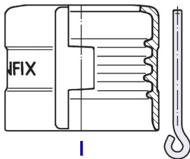
Enkel voor slangen met genormeerde afmetingen. Eenvoudige montage in een bankschroef zonder gespecialiseerd gereedschap (montagetips, zie pag. 222). Absoluut veilige vergrendeling door **roestvrijstaal** vergrendelingspin die niet spontaan kan losschieten. Enkel demonteerbaar in een bankschroef.
