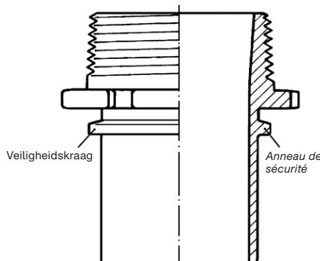
ELAFLEX propose 3 variantes de montage de sécurité pour les embouts de flexible. Elles se différencient seulement par leur système de serrage. Le cramponnage actif d'étanchéité et la résistance à la pression et à l'arrachement sont identiques. Les demi coquilles sont approuvés par les plus importantes compagnies pétrolières.
