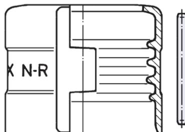
Montage zoals SPANNFIX, maar **niet demonteerbaar**. Zonder vernietiging van de klemschaal. Aangewezen bij slangen die na montage niet meer gewijzigd mogen worden zoals b.v. vliegtuigbetankings- en LPG-slangen. Goedgekeurd als equivalent van opgeperste slangkoppelingen.
