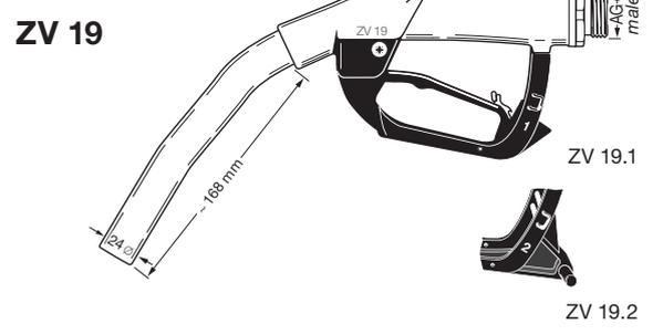
Pistolet ZV 19, non automatique, DN 19 (3/4") pour gazole, fuel, pétrole, huiles (aussi huiles végétales) jusqu'à max. 100 l/min. Pression d'utilisation jusqu'à 3,5 bar, avec ressort renforcé EF362 jusqu'à 5 bar.
