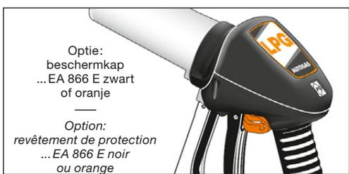
*Pistolet GPL selon ISO 19825 pour le remplissage des réservoirs de véhicules avec propane, butane et leurs mélanges jusqu'à 50 l/min. Pression de service 25 bar. Pression d'épreuve 40 bar. Pression d'éclatement > 100 bar. Plage de température - 40° à + 70° Celsius.*
