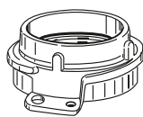
Type VK (Mannelijke koppeling in messing, RVS of aluminium)
